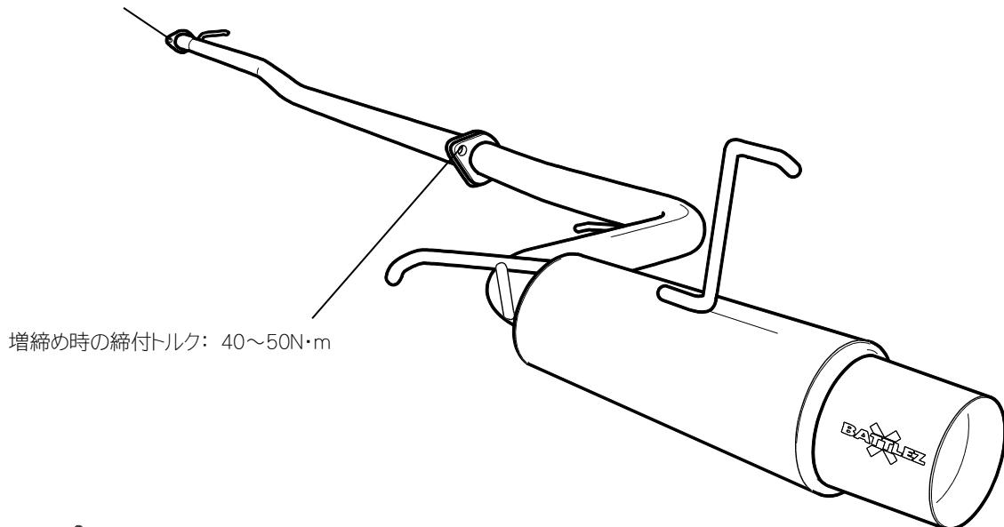
**！注意** ボルト類を締付ける場合は2点を交互に締付けるようにして下さい。偏った増し締めをするとガスケットがうまく密着せずに排気漏れを起こす原因となります。
