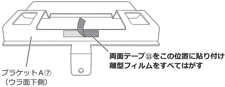
□ブラケットA⑦のウラ面下側中央に両面テープ⑩を貼り付け、離型フィルムをすべてはがします。
