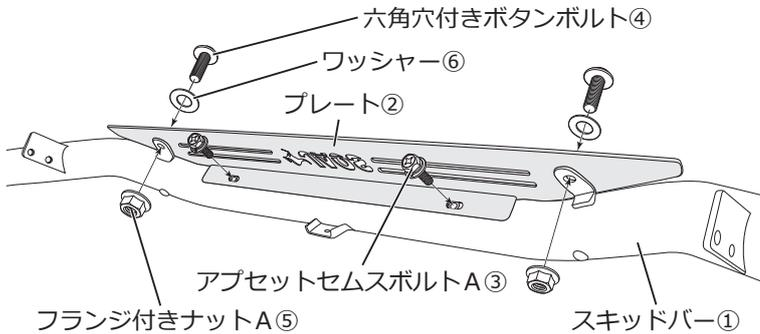
□図を参照し、スキッドバー①にプレート②を仮組みします。
