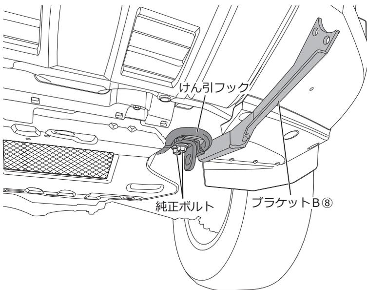
□ブラケットB⑧を組み合わせた「けん引フックASSY」を、純正ボルトでもとの位置に仮固定します。
