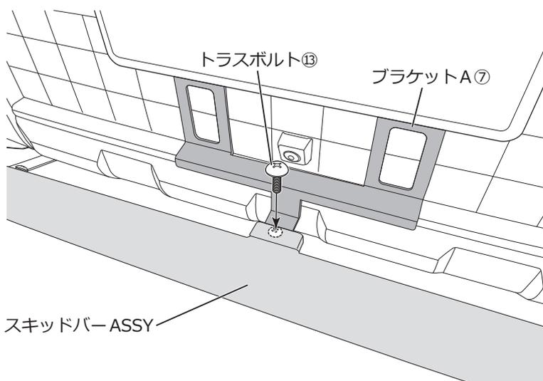
□スキッドバーASSY中央の固定部をブラケットA⑦の固定部に載せ、トラスボルト⑬で仮組みします。
