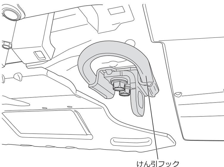
□車両から「けん引フック (左側)」「タイダウンフック (右側)」「ナンバープレート」を取り外します。
