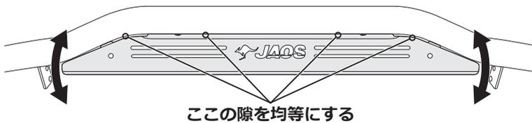
□図示の隙を確かめ均等になるよう調整し、仮締めしていたボルトを本締めします。
