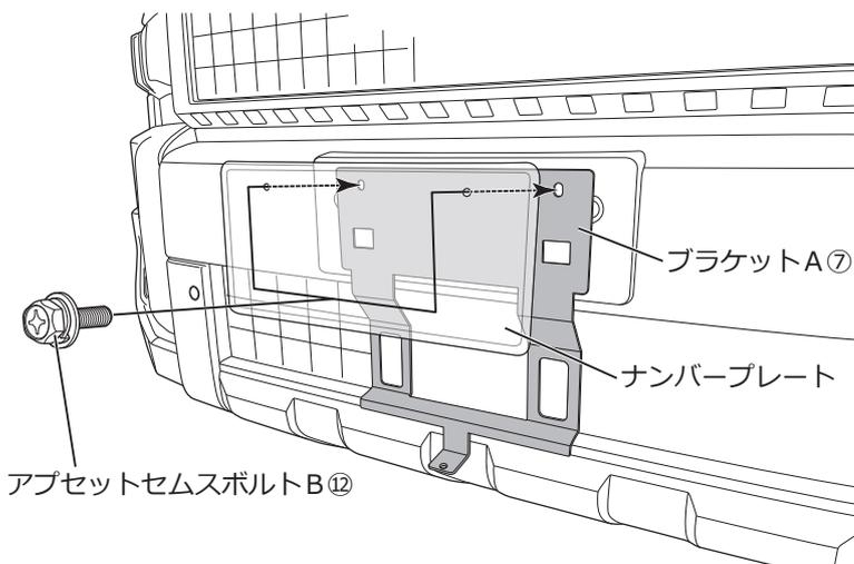
□ブラケットA⑦の穴位置に合わせてナンバープレートを重ね、アプセットセムスポルトB⑫で仮組みします。
