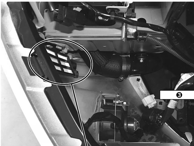
・ヘッドランプユニットの助手席側を取り外してから、その下に取り付けてあるインシュレーターを取り外します。●③
