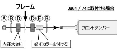
・フロントダンパーは車種によって取付け方法が異なります。図を参照し、付属部品を正しく組合わせ取付けてください。
