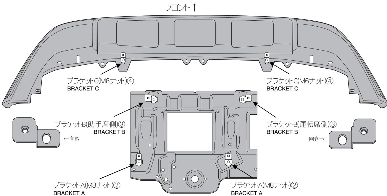
・図中の矢印で指示す箇所の純正ボルトを取り外し、各ブラケットと共に締めします。
