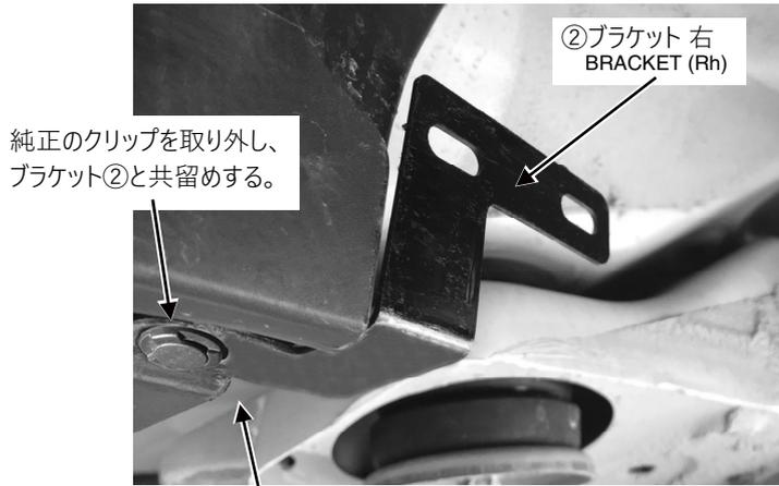
・左図のオーバーフェンダーを留めている純正クリップと左下図で見えている純正クリップ(オーバーフェンダー2点とインナーカバー2点)の部分を取り外します。
