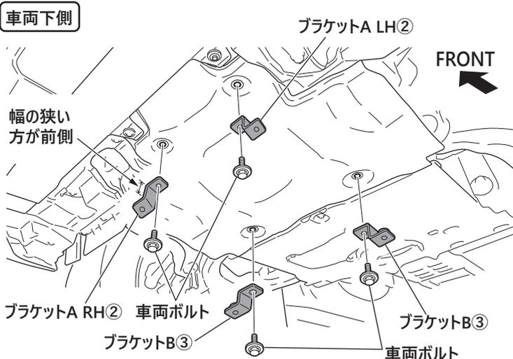
・図の位置の車両ボルトを使用して、ブラケット A ②とブラケット B ③を仮固定します。
