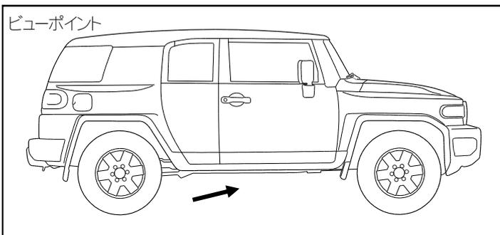
・サイドシル内側にあるサービスホールを利用し、ブラケットB③をフランジ付ボルト④にて仮止めします。
