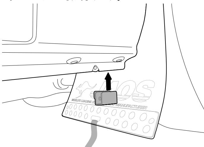
・サイドシルのフランジ接合部にブラケット②をはさみ、取り付けてあるビスを締め付けていきます。
