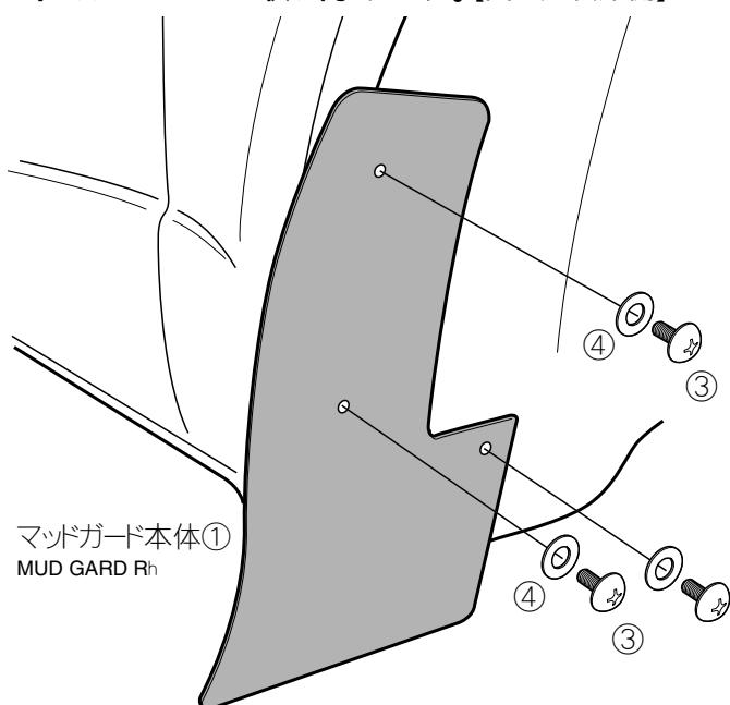
・タイヤハウス外側の穴2ヶ所は純正ボルトを取り外し、付属のボルトワッシャーなどで仮組みします。
