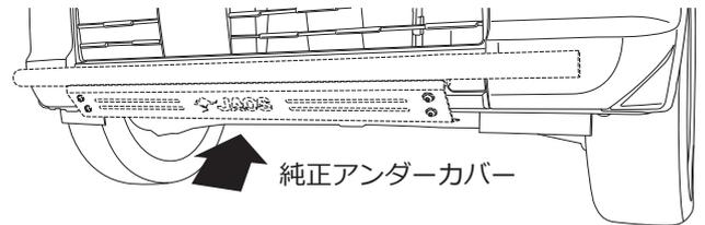
□フロントバンパー下部から純正アンダーカバーを取り外し、左図で示す部分をカットします。
