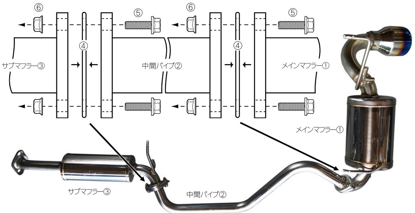
・中間パイプ②を図の様に配置し、各フランジの合わせり部分にガスケット④をはさみボルト類⑤⑥で仮組みします。
