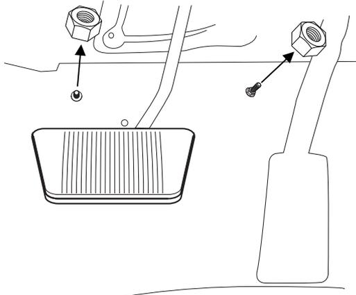
・車体側から伸びているボルトに止まっている樹脂ナットを取り外します。
