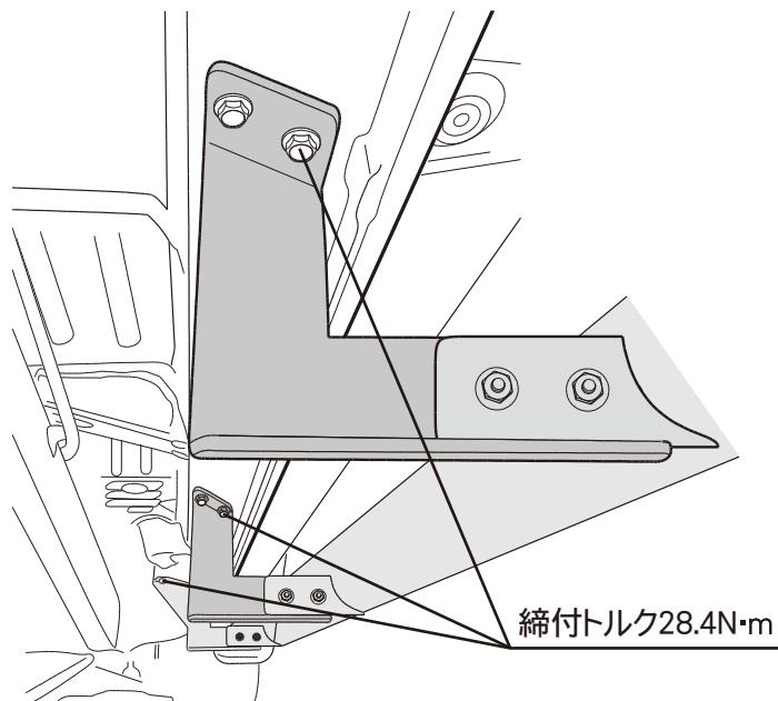
・仮止めしていた車体とブラケットを固定するボルト全12ヶ所を規定の締付トルクにて増し締めします。
