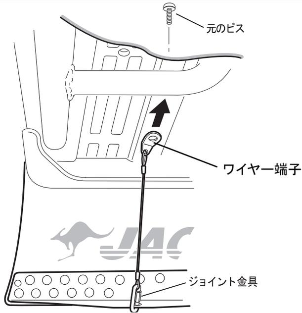
6. サイドステップと支えているパイプを固定しているビスを外してその間にワイヤー端子を挟み込み、一緒に共締めして下さい。
