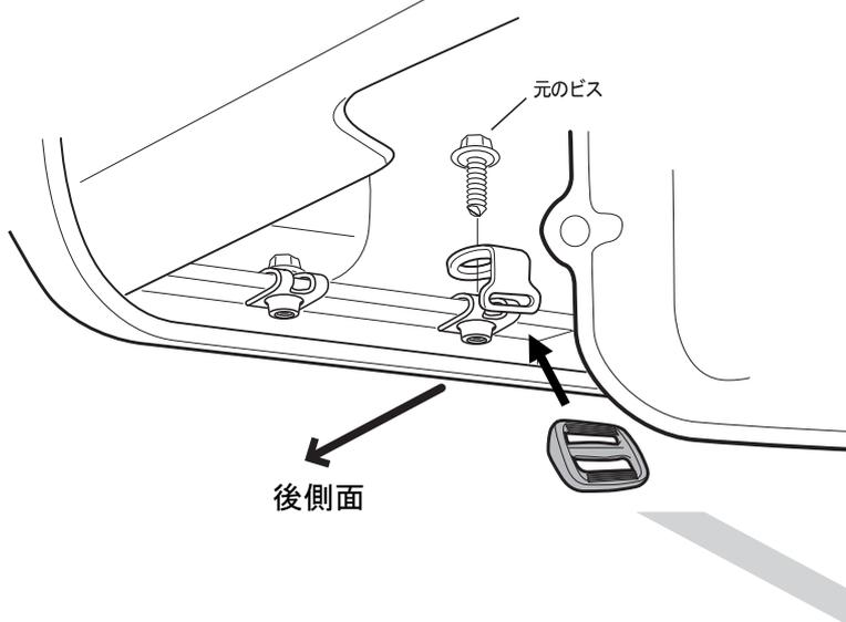
8. リヤバンパー後側面内側にある元のビスを外してステーを挟み込み、共締めして下さい。
