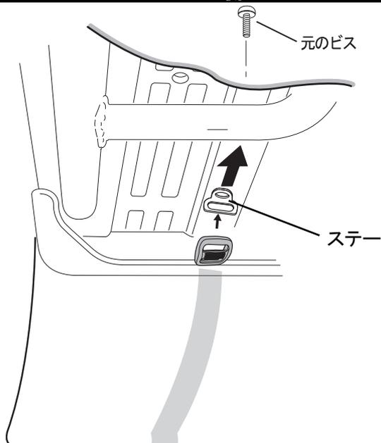
6. サイドステップと支えているパイプを固定しているビスを外してその間にステーを挟み込み、一緒に共締めして下さい。
