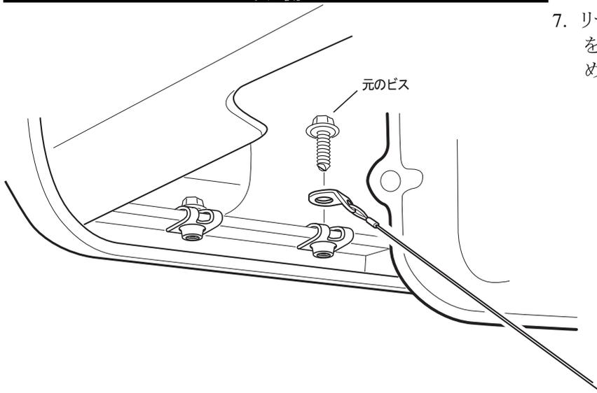
7. リヤバンパー後側面内側にある元のビスを外してワイヤー端子を挟み込み、共締めして下さい。
