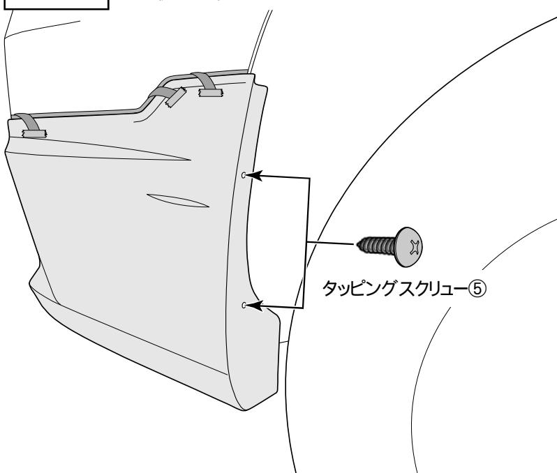
・フェンダー部をタッピングスクリュー⑤で仮締めします。
