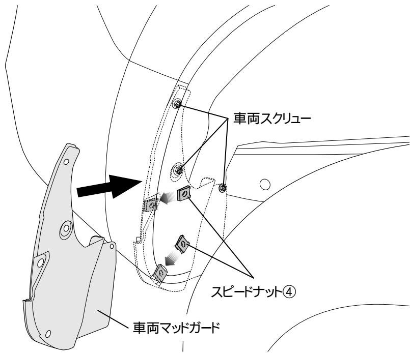
・図を参照し、リヤバンパーの車両クリップ部にスピードナット④を取付けます。
