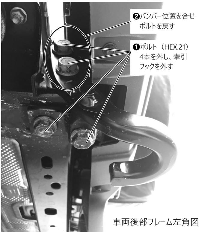
●1 フレーム左下にある牽引フック(ボルト4本)を取り外します。
