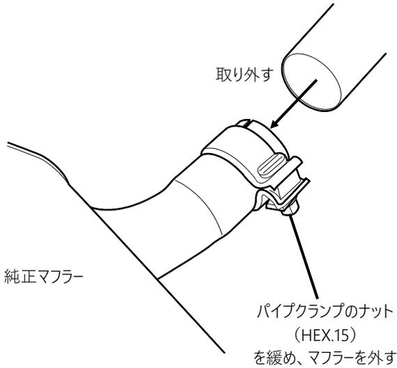
・純正マフラー、マフラーを吊っていたエキゾーストパイプサポート（吊りゴム）を取り外します。
