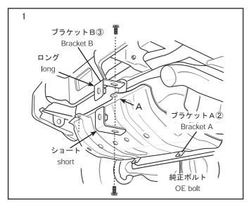
[1] 純正タンクガードリヤ側A部のボルトを外し、純正ボルトを利用してブラケットB を共締めしてください。
