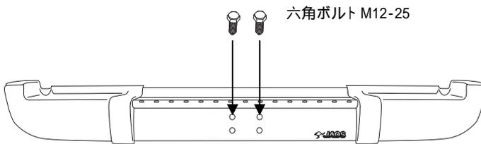
・ピントルフック取付穴の上2点に 六角ボルトM12-25を仮止めし位置を合わせてから本締めしてください。
