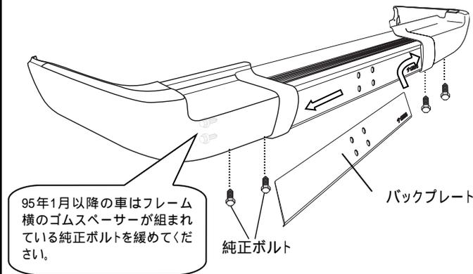
・純正樹脂バンパーの下部を固定している純正ボルト2点はずします。
