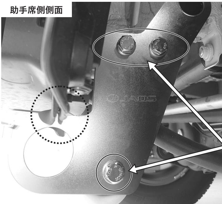
・牽引フック①上部のボルト穴2点は純正牽引フック上部のサービスホール2点と合わせ、六角ボルト④とワッシャー⑤を各ボルト穴(3点)へ差し込みます。
