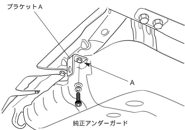
[1]純正アンダーガードの取付けボルト( A )部を外し、ブラケットA(2)をボルト(5.6.7)を使用して取付けてください。
