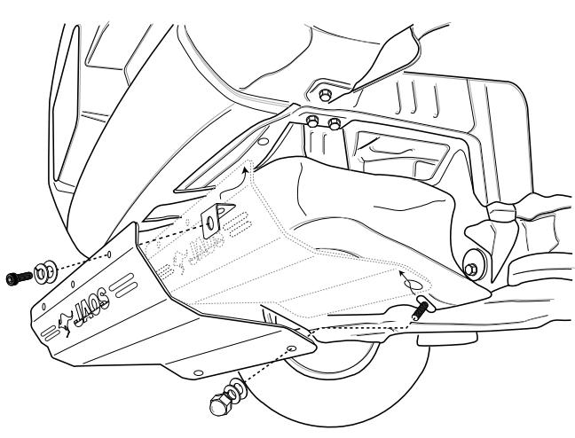
[3]取付けたブラケットA・Bにスキットプレート本体(1)を取付けてください。
