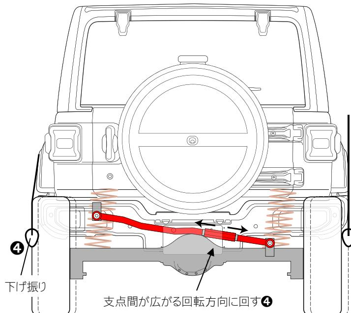
・ナット④を緩め、ターンバックル③を調整できるように準備します。(①)
