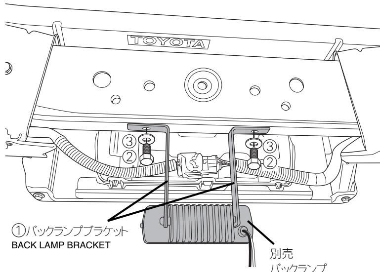
・純正ブラケットを取り外したボルト穴を利用し、バックランプブラケット①を付属のボルトを使い仮止めします。
