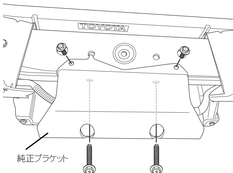
・後ナンバープレート裏にある純正ブラケットを取り外します。
