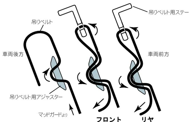
3. 吊りベルトの長さを決めカットします。
