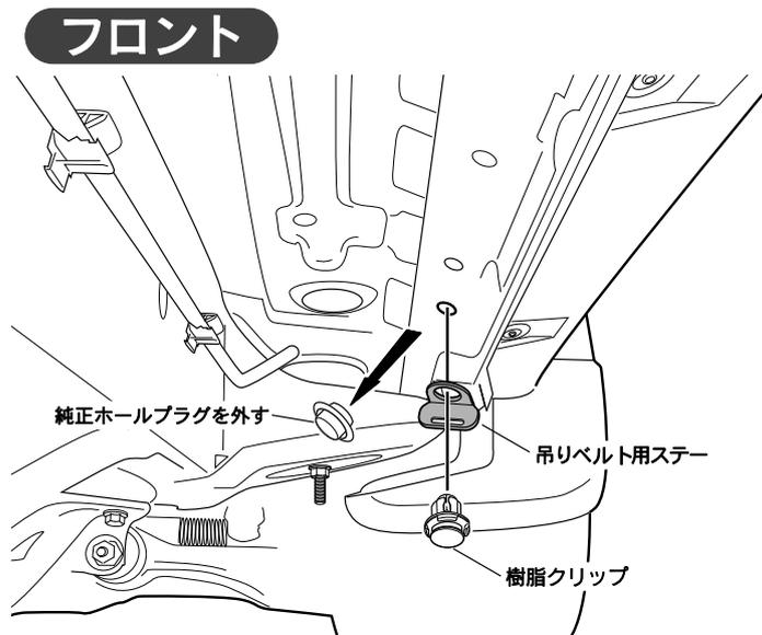
2. 図のように吊りベルトを吊りベルト用ステーへくぐらせ、吊りベルト用アジャスターでまとめます。
