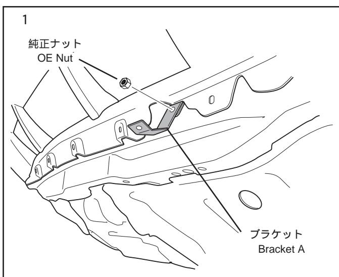
[1] 純正カバーを外して、図1のようにブラケットAを純正ナットを利用して仮止めしてください
