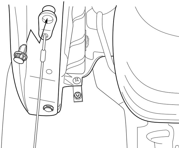
12. マッドガード本体に付属しているワイヤーキットを組み付け、リヤバンパーへクリップとワイヤー端子を一緒に取り付けて下さい。
