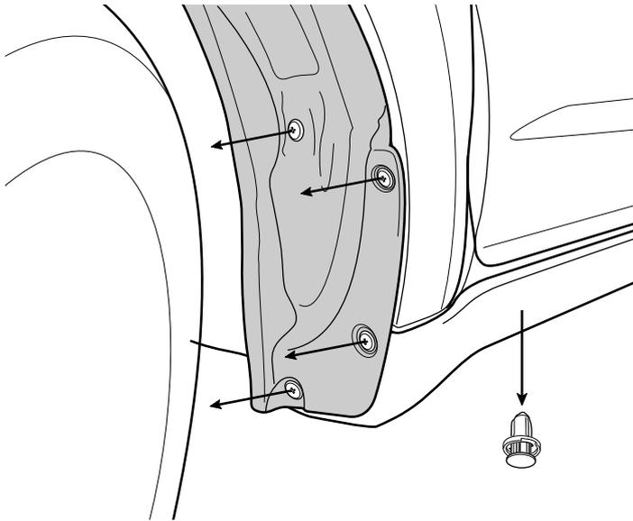
1. タイヤハウス内のインナーカバーを固定しているクリップ類を取り外して下さい。
