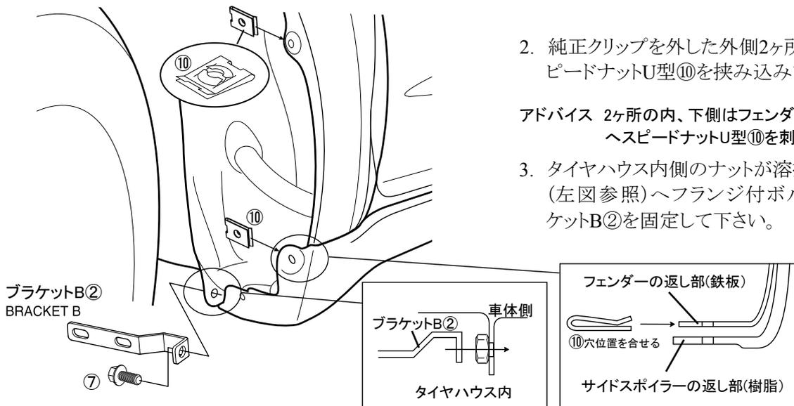
2. 純正クリップを外した外側2ヶ所(左図参照)へスピードナットU型⑩を挟み込みます。
