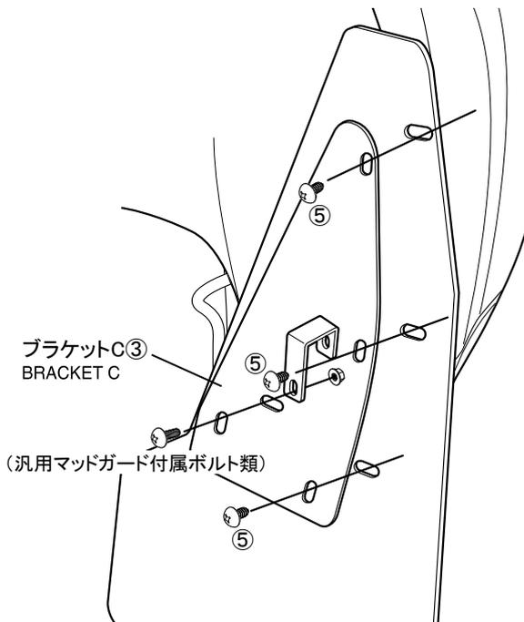
9. ブラケットC③を車体に添う様に軽く曲げ、スピードナットM5ワイド型⑨を取り付けた場所3ヶ所へトラスタッピングM5-20⑤を使用しマッドガード本体とブラケットC③を共締めし仮止めして下さい。
