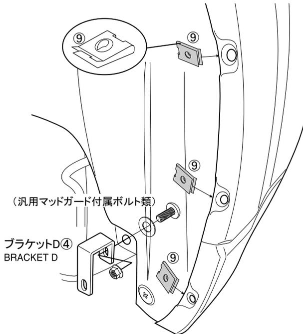
7. リアバンパーの折り返し部分にあるサービスホールへスピードナットM5ワイド型⑨を挟み込みます。
