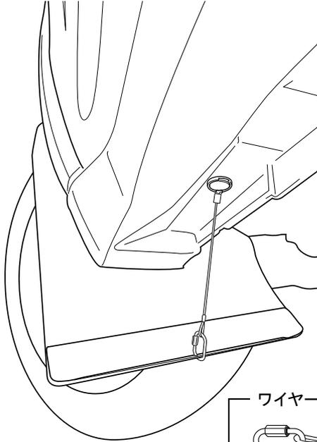
11. マッドガード本体に付属しているワイヤーキットを組み付け、サイドスポイラーへクリップとワイヤーを一緒に取り付けて下さい。
