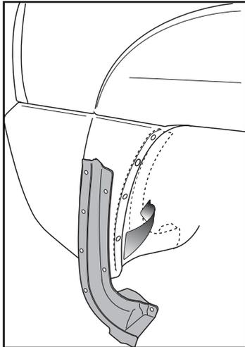
本品は210系サーフ用JAOSリヤマッドガードを取付ける際に必要とする純正のマッドガードの加工(一部カット)をせずにインナーカバー部を交換する補助部品です。
