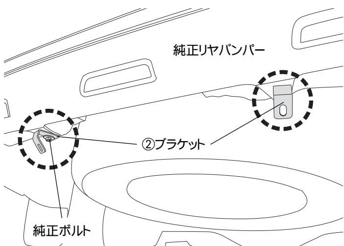
・図示の破線部に装着されている純正ボルトを一旦取外します。
