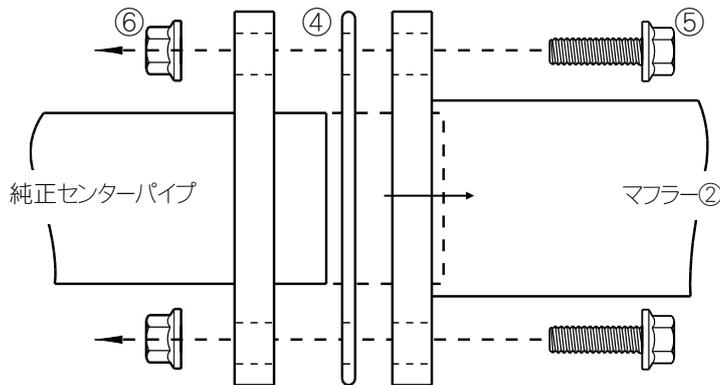
・純正センターパイプとマフラー②の間にガスケット④を合わせ、フランジ付ボルト⑤・フランジ付ナット⑥にて仮組みします。
