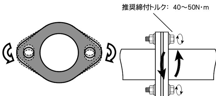
・バンパー側から見た位置関係を吊りゴムや各フランジ部の合わせなどで調整しながら、仮組みした箇所のボルト類を増し締めします。
