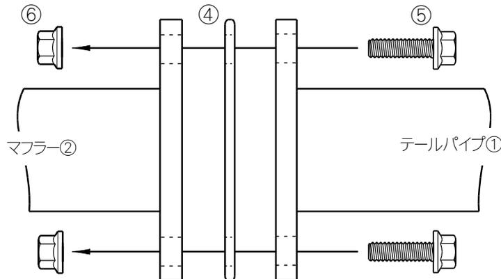
・マフラー②とテールパイプ①の間にガスケット④を合わせ、フランジ付ボルト⑤・フランジ付ナット⑥にて仮組みします。
