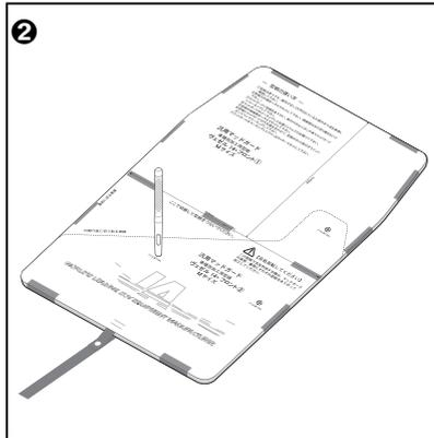
1. 型紙⑤の実線をハサミでカットしていき、フロントの1と2、リヤの1と2をつなぎ合わせます。(●1)
