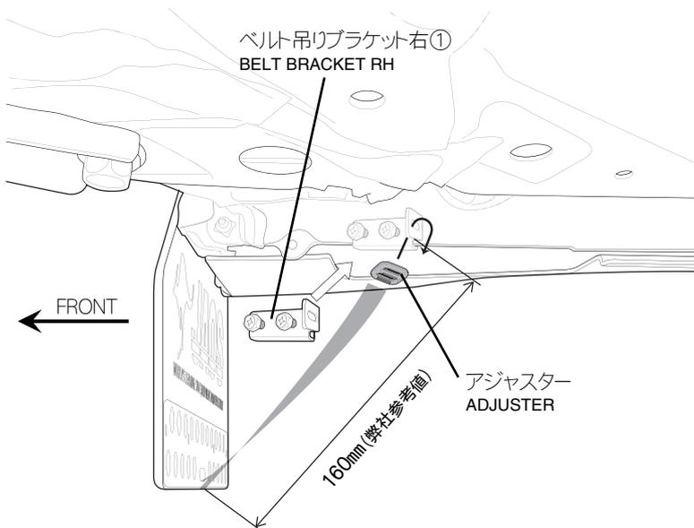
・サイドシルのフランジ接合部にベルト吊りブラケット①をはさみ、取り付けであるビスを締め付けていきます。
