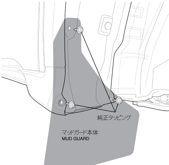
・純正インナーカバーとサイドスポイラーの部分にある純正タッピングを一旦取り外し、マッドガード本体を仮組みします。
