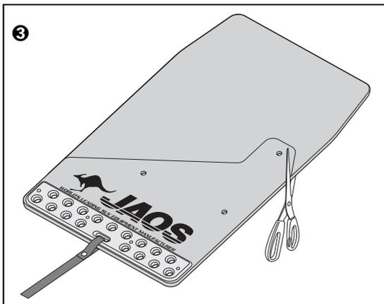
4. 型紙⑤をマッドガード本体から外し、型紙の破線をハサミでカットしていきます。
