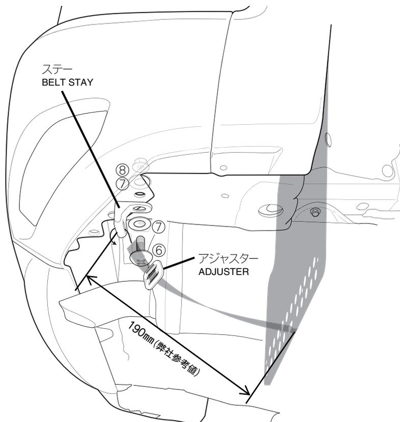
・汎用マッドガードに付属しているステアヘトラスボルト M6⑥とワッシャー-M6⑦を通し、インナーカバー裏に抜けたトラスボルトにワッシャー-M6⑦とフランジ付ナット M6⑧で固定します。(推奨締め付トルク5.0~6.0N・m)
