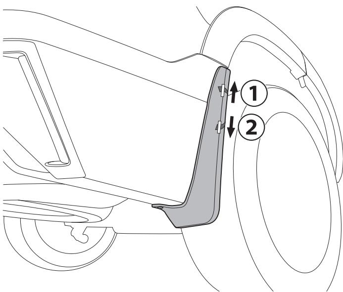
両面テープの離型フィルムを図の順に引き抜いて圧着します。
