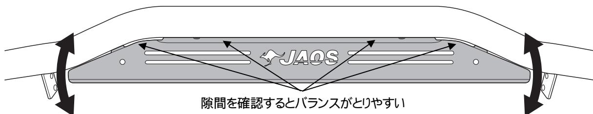
・プレートの取り付けバランスを確認したら、仮組みしていた部分を本締めします。
