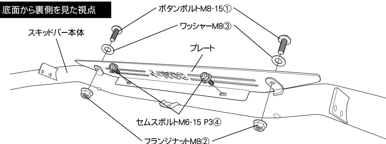
・スキッドバーのステーと埋め込みナットにプレートの穴位置を合わせます。
