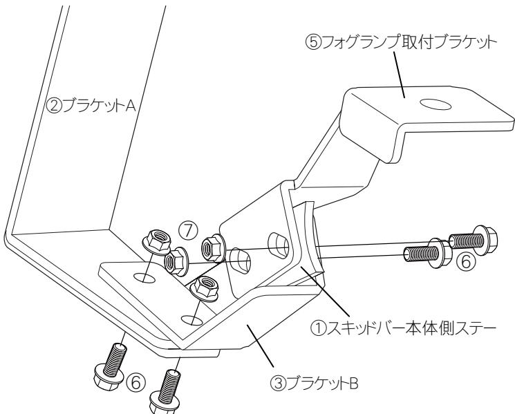
・ブラケットB③の内側へスキッドバー本体側ステー①がくる様に配置し、付属のボルト類で仮組みします。
