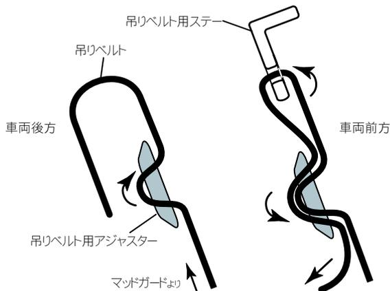
3. 吊りベルトの長さを決めカットします。
