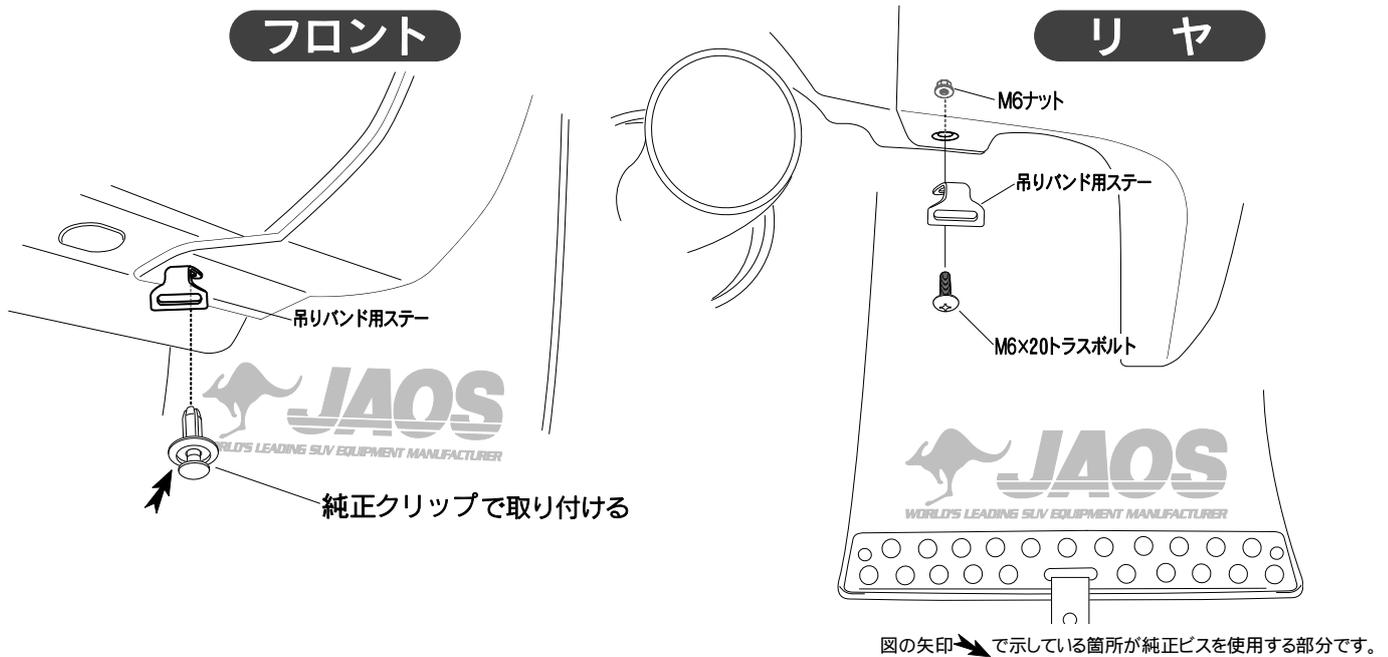
2. 下図のように吊りベルトを吊りベルト用ステーへくぐらせ、吊りベルト用アジャスターでまともめます。
