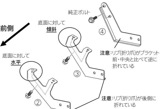
・取り外した純正ボルトを使用し、取り外した場所へ、各ブラケットを仮組みしていきます。
