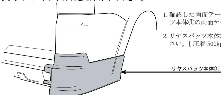
1. 確認した両面テープ接着面をきれいに清掃して、リヤスパツツ本体①の両面テープ離型紙を剥がして取付けて下さい。
