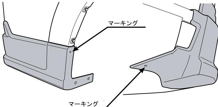
1. 取付確認後リヤスパツツ本体①の左右にタッピングスクリュー⑤固定位置をマーキングをして下さい。
