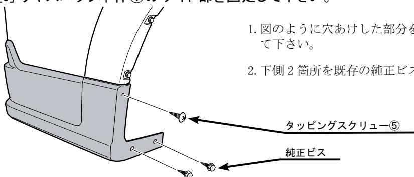
1. 図のように穴あけした部分をタッピングスクリュー⑤を使用して固定して下さい。
