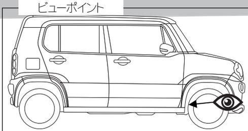
・インナーカバーとフェンダーの爪折部の純正クリップ3点を取り外します。(●①)
