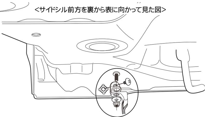
・サイドシルのフランジ接合部のサービスホール(ナット溶接あり)にブラケットB③とブラケットC④を取り付けます。
