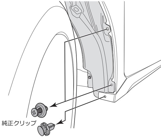
□図の3箇所から純正クリップを取り外します。
