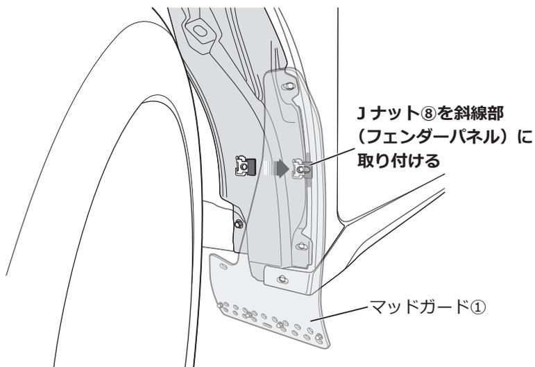
□フェンダーパネルの穴位置に合わせてマッドガード①をあてがい、図の箇所にJナット⑧を取り付けます。
