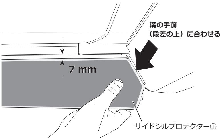
□図のようにサイドシルプロテクター①を車両のサイドシルにあてがい貼り付け位置を確認し、位置がずれないよう養生テープなどで仮固定します。
