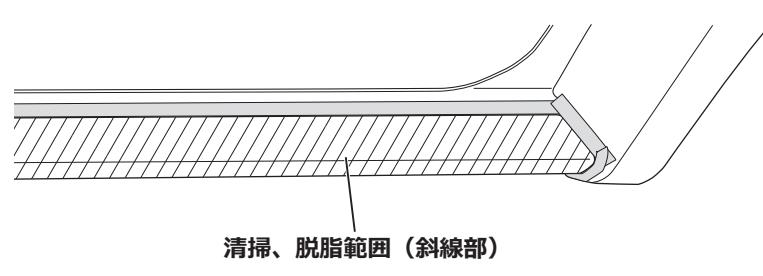
□サイドシルプロテクター①をいったん外し、貼り付け部（斜線部）の汚れを取り除き、IPAまたはホワイトガソリン（洗浄用）で一方向に拭いて脱脂します。
