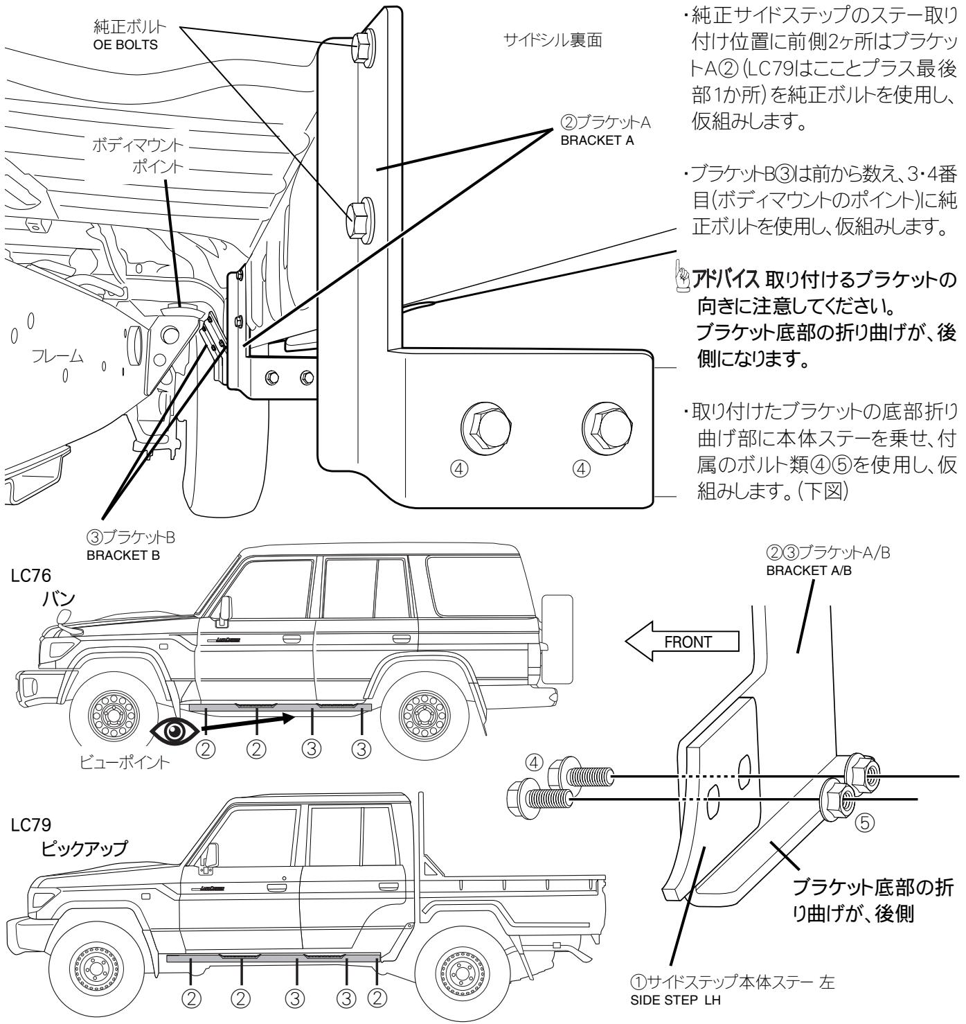
・サイドステップ本体の位置を左右で同じなる様に調整し、増し締めします。
