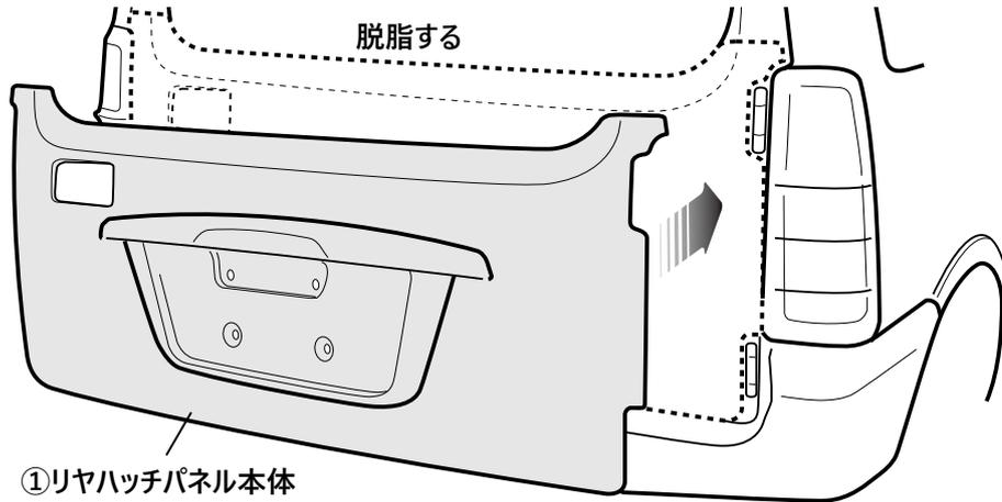
・リヤハッチパネル本体①を一旦バックドアにあってがい、取付位置の基準点決めと両面テープが接触する面を確認し、脱脂をしておきます。
