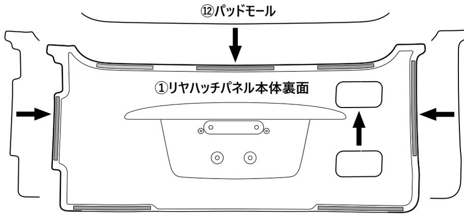
・パッドモール⑫の貼り付け箇所を脱脂し、リヤハッチパネル本体①と車体の干渉箇所へパッドモール⑫を貼付けます。
