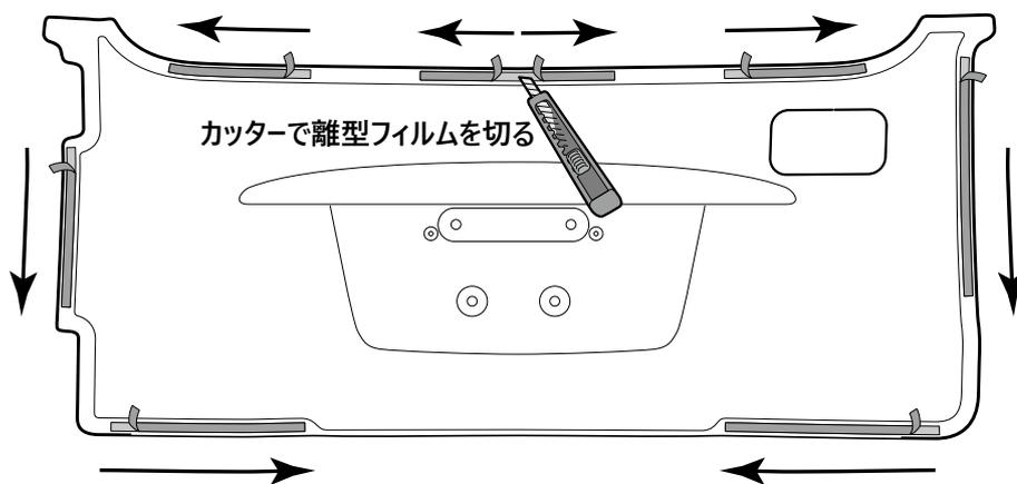
・リヤハッチパネル本体①の両面テープの離型フィルムを左図のように一部剥がし、表面に折り返してマスキングテープで貼付けます。
