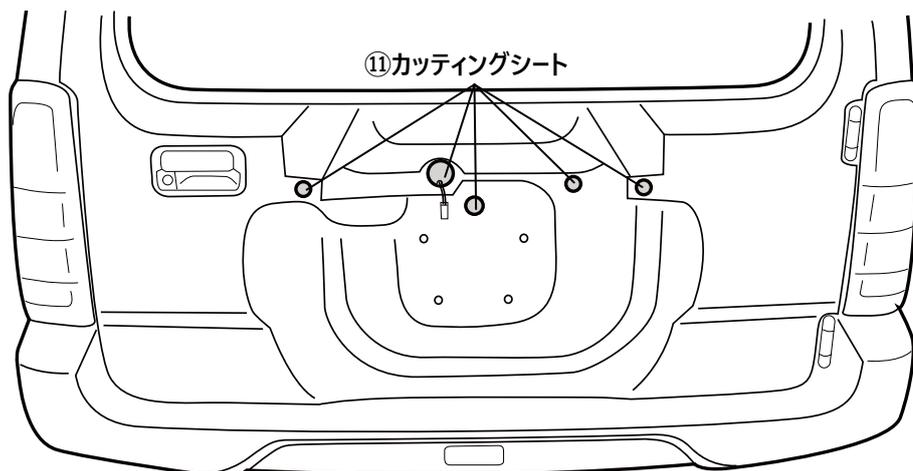
・バックドアの使用しない穴にカッティングシート⑪を貼り、穴を塞ぎます。
