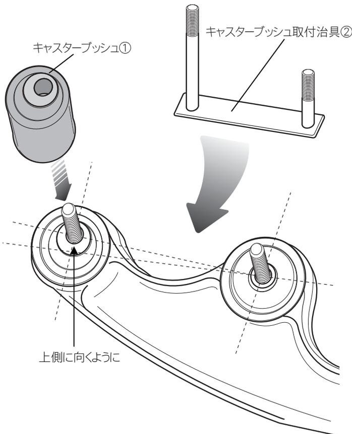
・リーディングアームを取り外し、油圧プレスなどを使用し、前側の純正ブッシュを抜き取ります。
