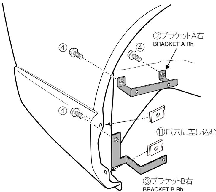
・タイヤハウス裏側(リヤバンパー側)のサービスホールからフランジボルト④を差し込み、ブラケットA②・ブラケットB③を取り付けます。
