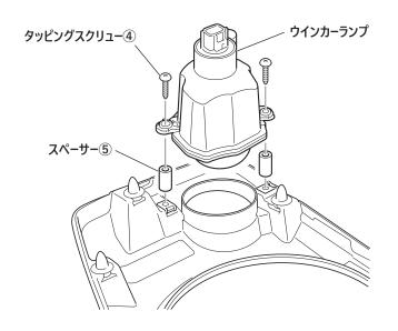
純正フロントグリルから取り外したウインカーランプをフロントグリルインナー②にタッピングスクリュー④とスペーサー⑤を使用して取り付けます。
