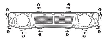
・上下左右のバランス、隙、穴位置などのズレがない ことを確認し、折り返した両面テープの離型フィルムを 図の順に引抜きながら圧着します。
