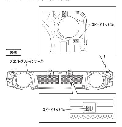
• フロントグリルインナー②の図の部分にスピードナット③を 取り付けます。
