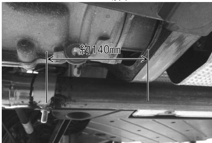
・左右のアーム間のメンバーを基準点に約 140mm の位置でマフラーパイプをマーキングし、切断工具を使い切断します。
