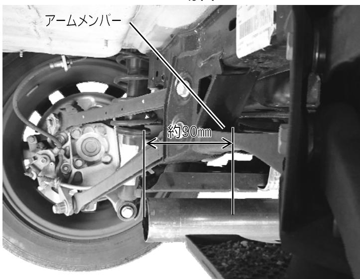
・左右のアーム間のメンバーを基準点に約 90mm の位置でマフラーパイプをマーキングし、切断工具を使い切断します。
