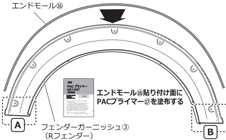
□図を参照し、フェンダーガーニッシュ<sup>③</sup> (Rフェンダー) のエンドモール<sup>⑬</sup>貼り付け面に、PACプライマー<sup>⑰</sup>を塗布します。
