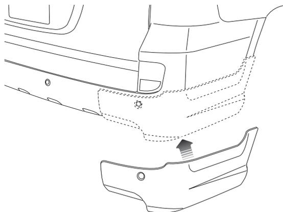
1.リヤスパッツ を一度バンパーにあてがって、取付位置とフィッティング、また両面テープ接着面の位置を確認して下さい。
