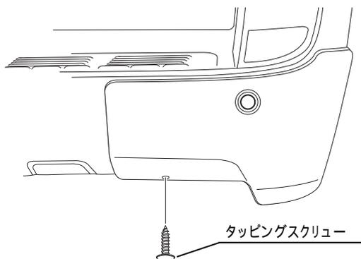
1.左図の位置に純正タッピングスクリュー及び純正クリップを仮止めして下さい。
