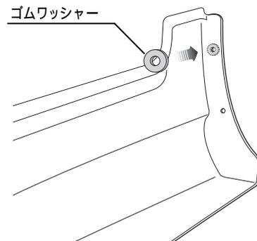
**!** 注意 モール・両面テープ・ゴムワッシャーの接着面は汚れをきれいに清掃し、必ずクリーナー100で脱脂して下さい。
