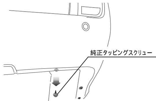
1.図の位置の純正タッピングスクリューを取外して下さい。
