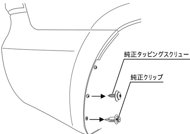
1. 左図の位置の純正タッピングスクリュー及びクリップを取外して下さい。
