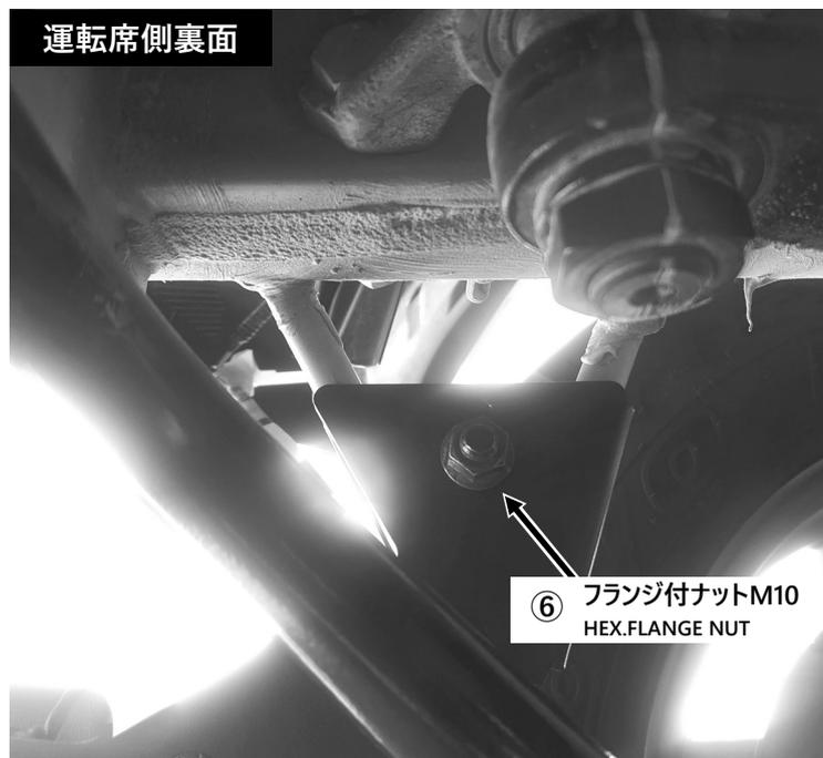
・フランジ付ボルト④を差し込んだ反対側からフランジ付ナット⑥で仮組みします。
