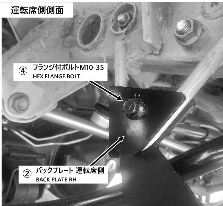
・運転席側同様、牽引フック内側に本体①のステーの凸部がはめ込まれている事を確認し、逆側からバックプレート運転席側②を合わせフランジ付ボルト④を差し込みます。
