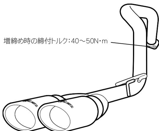
**!** **注意** ボルト類を締付ける場合は2点を交互に締付けるようにしてください。偏った増し締めをすると取り付け際にテールがバンパーに接触したり、ガスケットがうまく密着せず排気漏れを起こす原因となります。
