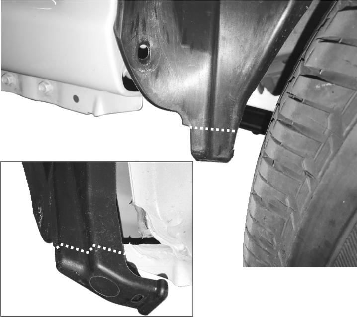
・タイヤハウスイナーを固定している樹脂クリップ（下図3点）を取り外し、インナーの最下点にある車体のフランジ部をカバーしている部分（左図白破線部）をニッパーなどで切り取ります。
