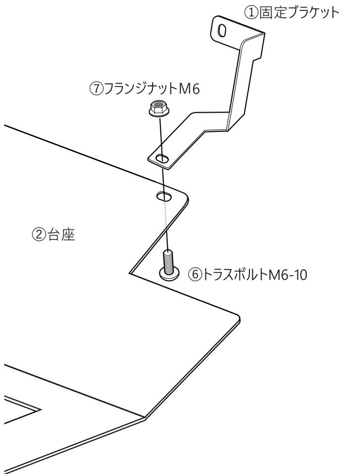
・台座②に固定ブラケット①をトラスボルトM6-10⑥とフランジナットM6⑦を使い仮組みします。
