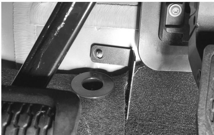
・ダッシュパネルの埋込ボルトは台座を樹脂頭ナットで取り付けたらフロアカーペットのグロメットはまだ取り付けず、ゴムマットだけを戻します。
