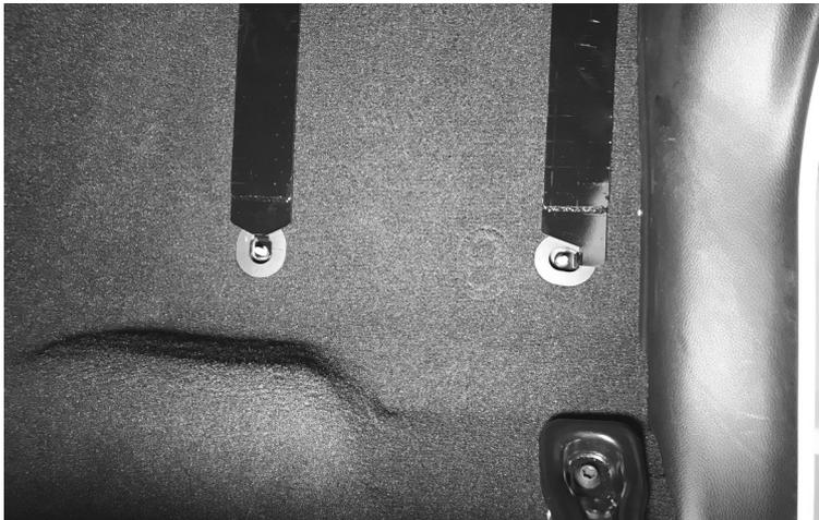
・フットレスト②を仮組みした台座①をフロアカーペット上に置き、各埋込ボルトへ取り付け、樹脂頭ナットで仮組みします。
