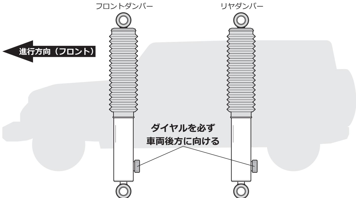
**△ 注意** 減衰力調整用ダイヤルを必ず図と同じく車両後方に向け製品を取り付けてください。
